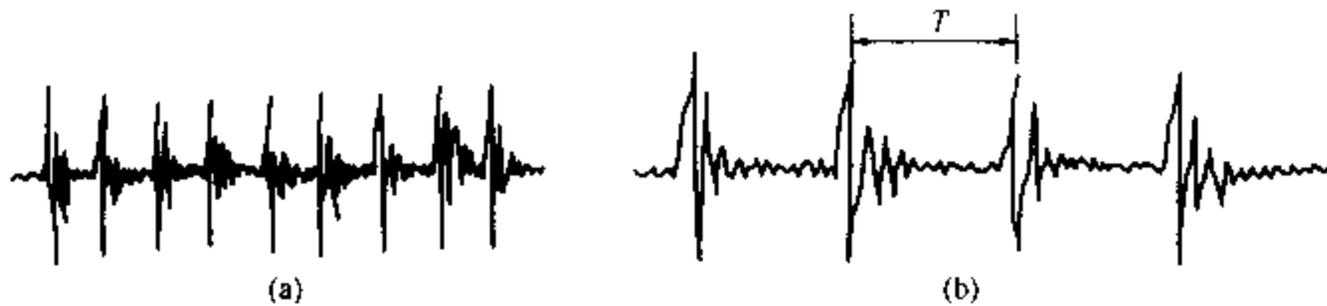
图 11-11 有疲劳剥落故障轴承的振动信号
