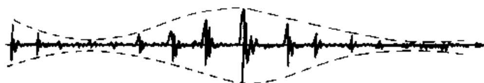
图 9-26 偏心齿轮的振动时域波形
